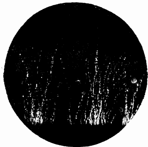
Рис. 342. Фотография неполного пробоя стекла. Длительность импульса 10^{-8} сек. Увеличено в 35 раз. (По Вальтеру и Инге).
