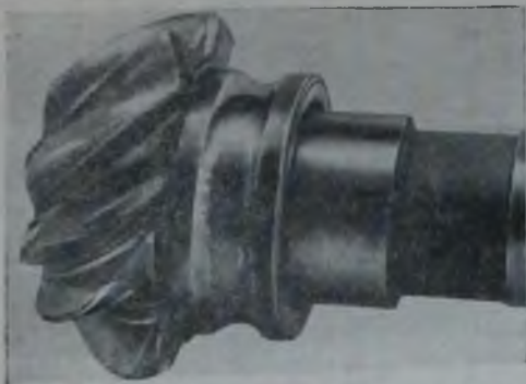
Фиг. 162. Ведущая шестерня заднего моста, сломавшаяся по зубу.
