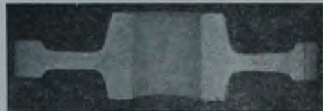
Фиг. 105. Поперечный макрошлиф шестерни, показанной на фиг. 104.
