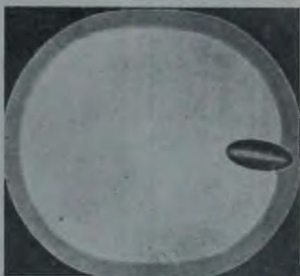
Фиг. 89. Закаленный слой, подвергавшийся испытанию на смятие.
