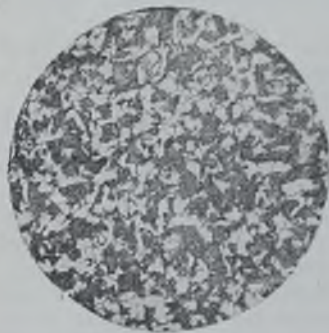
Фиг. 9. Структура стали — сорбитообразный перлит и феррит.
