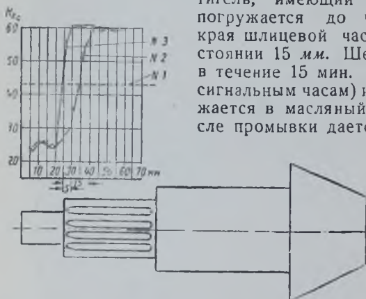
Фиг. 113. Схема распределения твердости в сердцевине и по поверхности резьбового и шлицевой концов ведущей шестерни заднего моста после различных режимов термической обработки:
