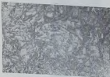
а б Фиг. 106. Микроструктура поверхности зубьев шестерен.
