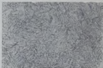
Фиг. 180. Структура, состоящая из троостомартенсита.
