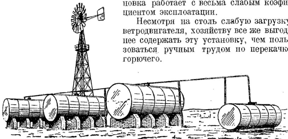
Фиг. 139. Ветронасосная установка ВД-5 м для перекачки горючего.
