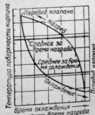
Рис. 49. Изменение температуры поверхности кирпича (в одной точке) за цикл.
