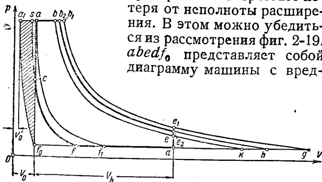
Фиг. 2-19. Потеря от неполного сжатия (вредного пространства) в машине с неполным расширением пара.
