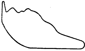
Фиг. 2-45. Индикаторная диаграмма, искажение которой вызвано ударом воды в индикаторе или слишком слабой пружиной, не преодолевающей сил инерции движущихся масс индикатора.
