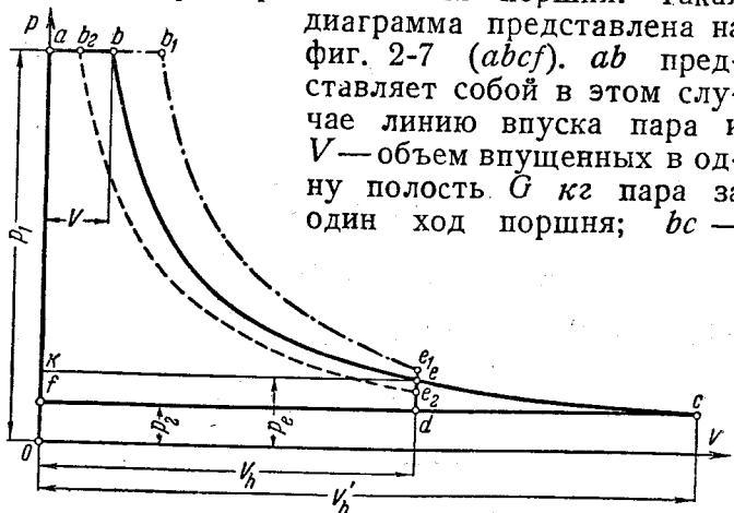
Фиг. 2-7. Индикаторные диаграммы цикла Ренкина и цикла с неполным расширением пара.
