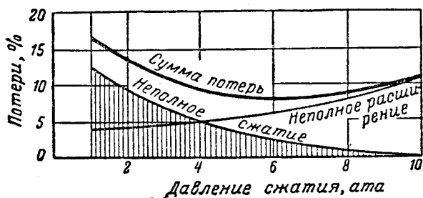
Фиг. 2-20. Выбор наиболее выгодного давления сжатия ( p_1=10 \text{ ата} ; p_2=1 \text{ ата} ).
