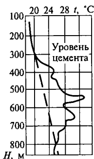
Рис. 10.22. Температурная кривая для определения высоты подъема цементного раствора за обсадной колонной
