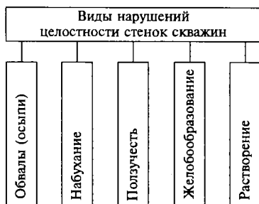
Рис. 6.1. Классификация нарушений целостности стенок скважины (по Ю. В. Вадецкому)
