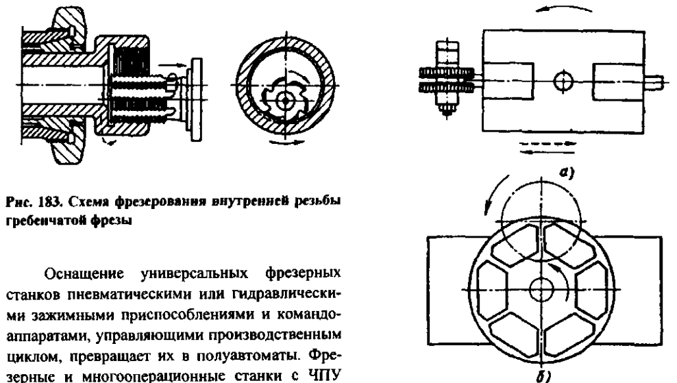
Рис. 184. Схемы фрезерования заготовки: а – на поворотном столе с двумя приспособлениями; б – на вертикально-фрезерном станке с вращающимся столом
