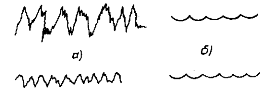
Рис. 11. Изменение шероховатости поверхности при ОУО ППД на упрочняющих режимах: а — исходный профиль шероховатости; б — сформированный профиль шероховатости
