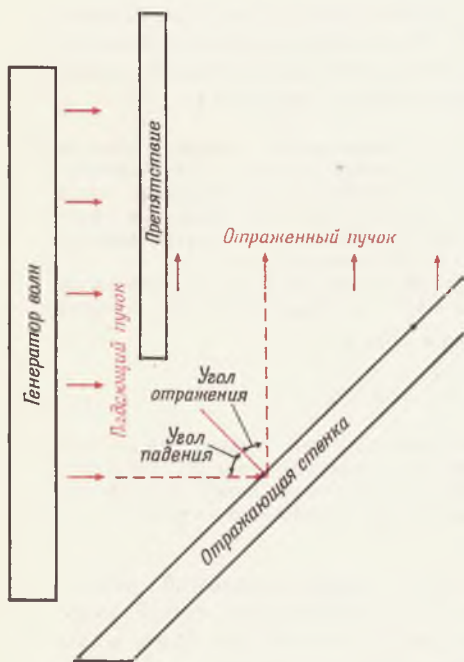
Фиг. 225. Иллюстрация закона отражения с помощью волн на поверхности воды.
