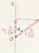
Фиг. 277. Пространственное квантование вектора момента количества движения в терминах квантовых чисел l и m_l .
