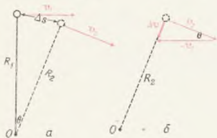
Фиг. 20. Два последовательных положения тела, равномерно движущегося по окружности (а), и вектор \Delta v = v_2 - v_1 (б).
