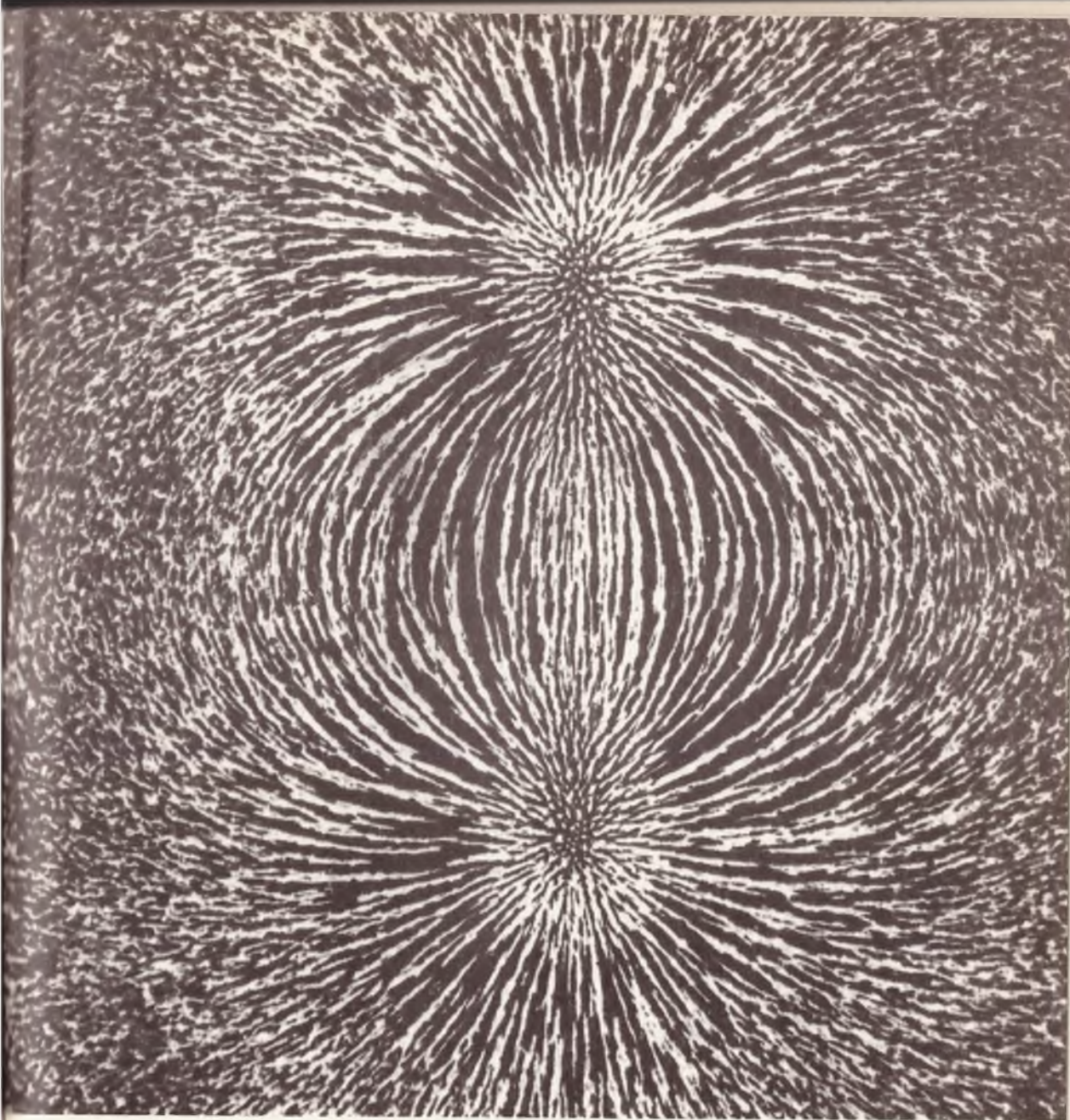
Фиг. 158. Силовые линии магнитного поля, созданного намагниченным стержнем, полученные с помощью железных опилок.
