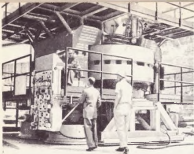
Фиг. 111. 72-дюймовая пузырьковая камера, оборудованная «шагающим» приспособлением.
