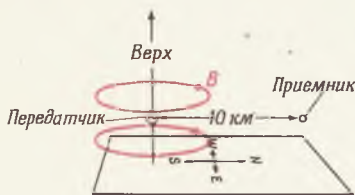
Фиг. 204. Вертикальная антенна. Показаны силовые линии излучаемого магнитного поля.
