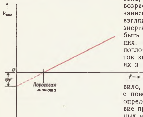
Фиг. 258. Зависимость (E_{\text{кин}})_{\text{макс}} от частоты для металла с работой выхода \mathcal{W} .
