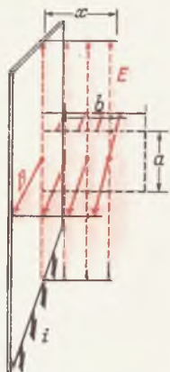
Фиг. 167. Электрическое и магнитное поле волны, испускаемой поверхностным током плотностью iCGSE(I)/\text{см} . Электромагнитная волна прошла расстояние x .
