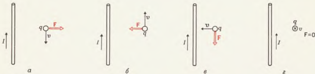
Фиг. 146. Направление магнитной силы F_m при различных ориентациях v .
