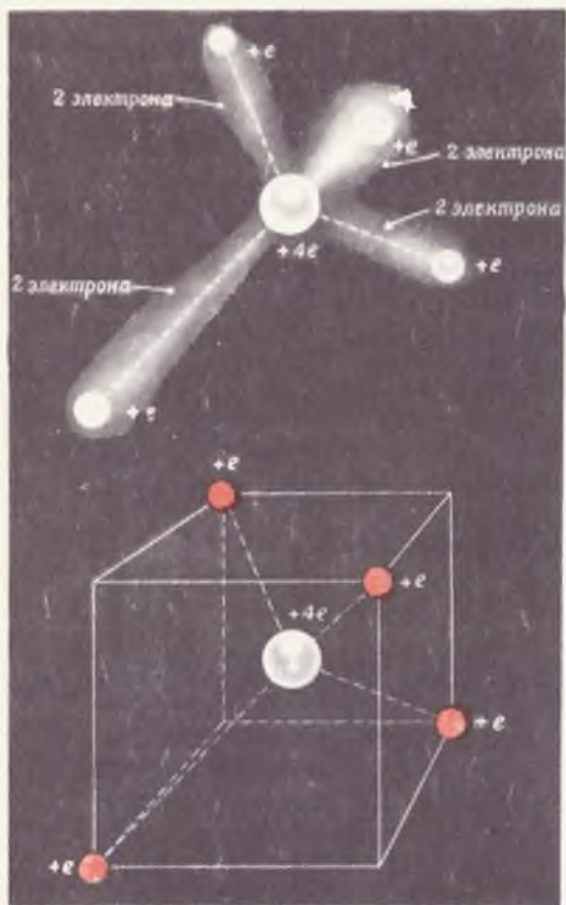
Фиг. 292. Качественный рисунок, иллюстрирующий электронную структуру метана.
