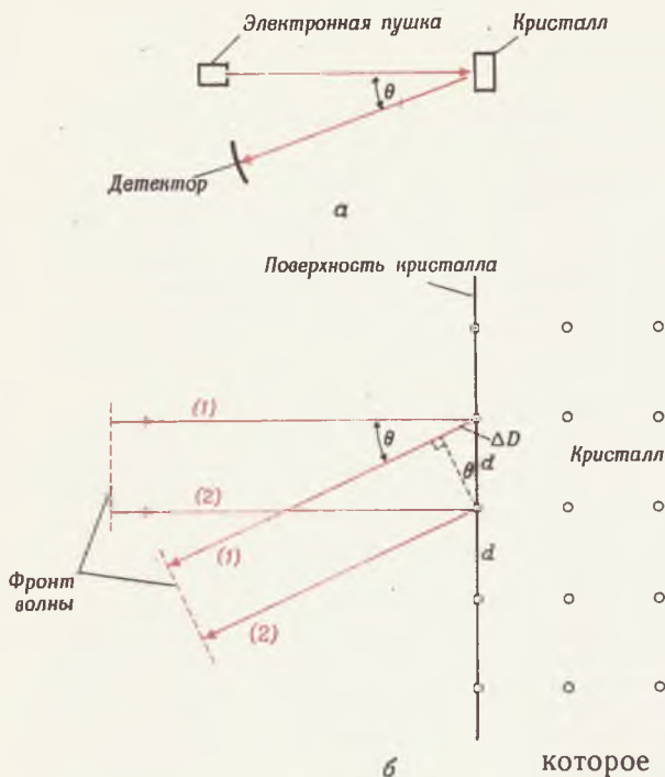
Фиг. 267. Прибор для наблюдения дифракции от поверхности кристалла (а) и та же поверхность, сильно увеличенная (б).
