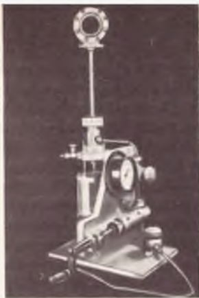
Фиг. 109. Фотография первой пузырьковой камеры, изготовленной целиком из металла.
