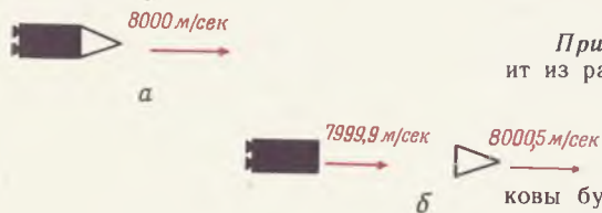
Фиг. 35. Ракета до освобождения головного конуса (а) и после срабатывания пружины (б).
