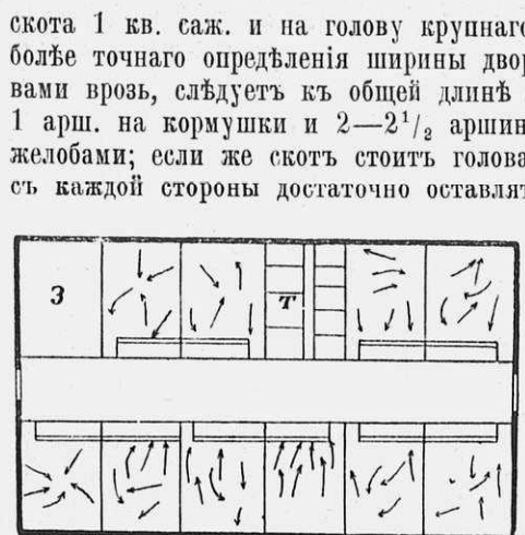
Рис. 27. Планъ хлѣва съ поперечными стойлами и групповымъ содержаніемъ скота на свободѣ.
