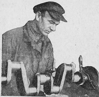
Рис. 2. Проточка коленчатого вала на токарном станке
