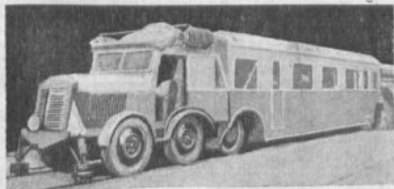
Рис. 1. Рейлкар Мишлеи — тягач с полуприцепом
