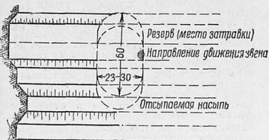
Рис. 5. Эллиптический способ перемещения грунта волокушами
