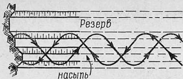
Рис. 7. Зигзагообразный способ перемещения грунта волокушами
