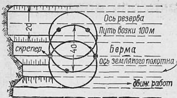
Рис. 4. Круговой способ перемещения грунта скреперами-волокушами
