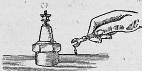
Рис. 5. Проверка провода высокого напряжения
