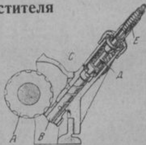
Рис. 2. Разрез нижней головки гибкого вала привода Воксхолл
