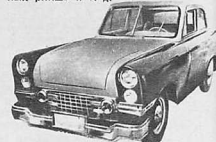
Рис. 3. Легковой автомобиль «Прогресс» с двигателем 95 л. с. Производством «Машиностроительной фабрики Хинчун» в Чунчине.
