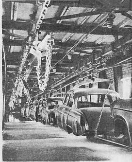
Подвесной конвейер для транспортировки кузовов.
