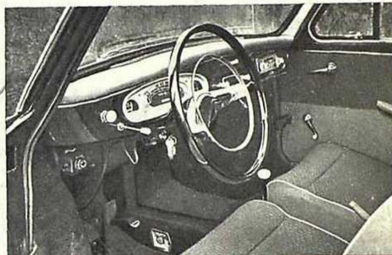
Так выглядит «рабочее место» водителя. Обратите внимание на штурвал и щиток приборов.
