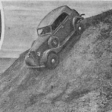
Испытания надежности тормозов на крутом спуске
