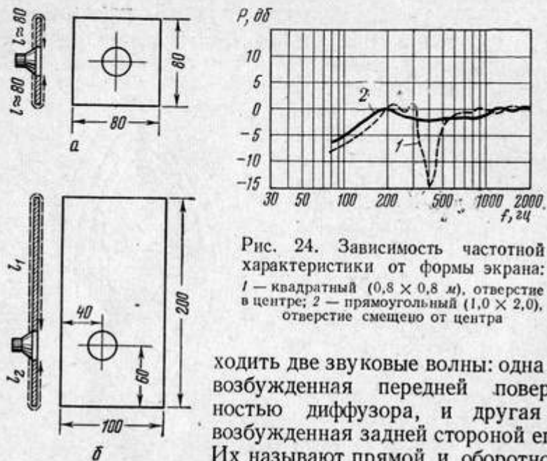
Рис. 23. Акустические экраны (размеры в см): а — неудачный; б — удачный
