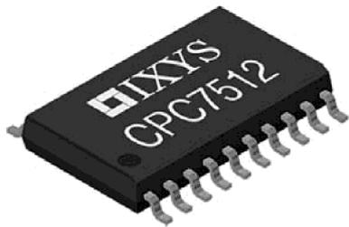
мально разомкнутыми контактами. Коммутатор выполнен в корпусе SOIC20 и может коммутировать сигналы высокого напряжения до  $\pm 320$  В. Миниатюрное твердотельное устройство обеспечивает функционал двух нормально-разомкнутых твердотельных реле SSR в высокочастотных приложениях (до 60 дБ на частоте 1 МГц). CPC7512 сконфигурирован как два независимых коммутатора с оптимизированным управлением состояниями.
