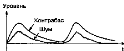
Рис. 2.65. К пояснению «дыхания шипения» в такт с громким НЧ сигналом
