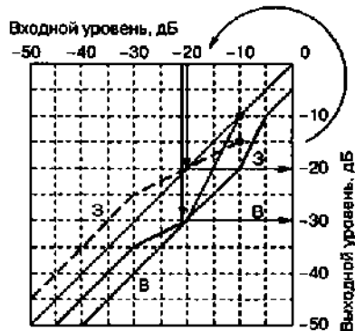
Рис. 2.20. К объяснению неточного согласования опорных уровней Dolby level кодера и декодера
