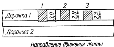
Рис. X. 9. Расположение магнитных головок относительно магнитной ленты при двухдорожечной записи.
