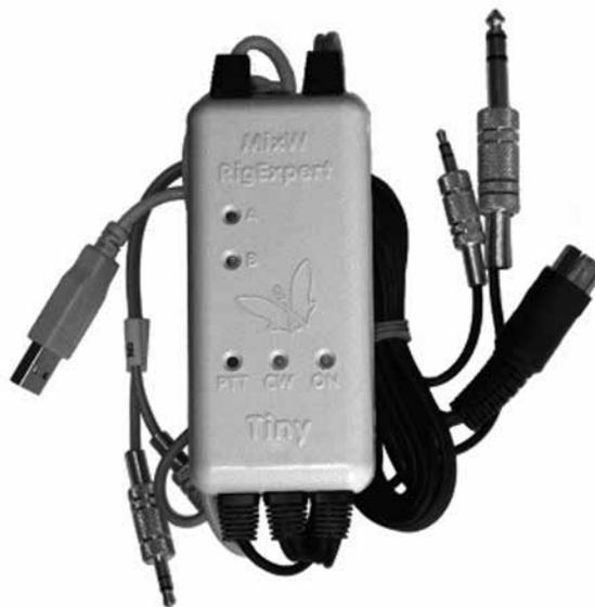
*Рис. 9.2. Интерфейс «RigExpert Tiny»*
