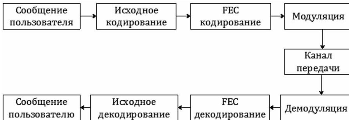
**Рис. 9.4. Блок-схема информационных потоков в системе цифровой связи**
