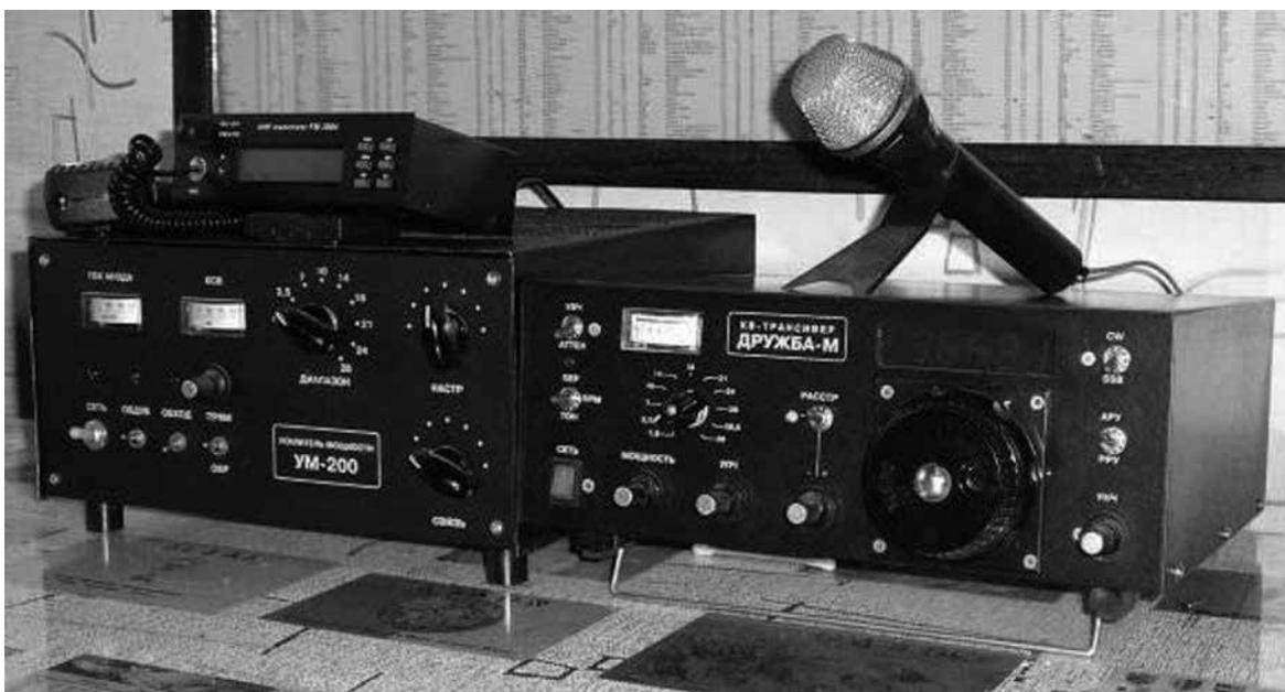
**Рис. 2.7. Трансивер «Дружба-М» и усилитель мощности «УМ-200»**
